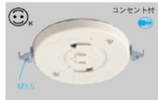
④WG6420WK 希望小売価格 820円(税抜) コンセント付丸型引掛埋込ローゼット(ミルクキーホワイト) (送り端子付) 6A125V
